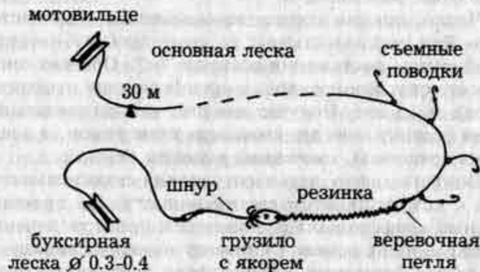
Рис. 37. Схема устройства короткой донки с резинкой
