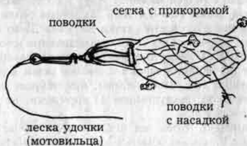
Рис. 18. Донка с сетчатой кормушкой для стоячей воды
