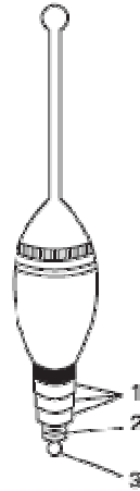
Рис. 50. Самоогруженный поплавок с шайбами на киле: 1 – шайбы; 2 – резьба кия; 3 – монтажное колечко
