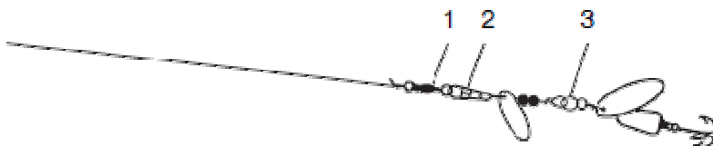
Рис. 12. Тандем из двух блесен: 1 – вертлюжок; 2 – карабин; 3 – заводное колечко
